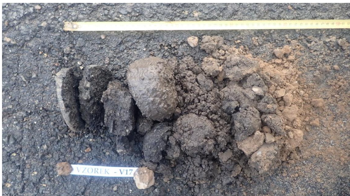
Obr. 33 - Jádro vývrtu Vzorek – V17 (in situ).
