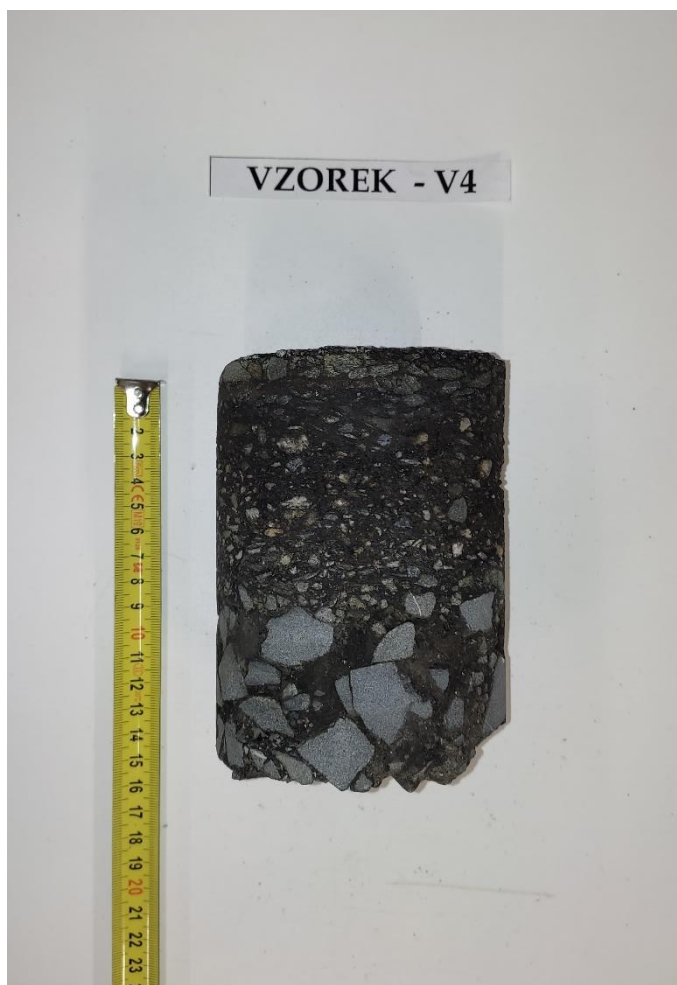
Obr. 8 - Jádro vývrtu Vzorek – V4 (laboratoř).
