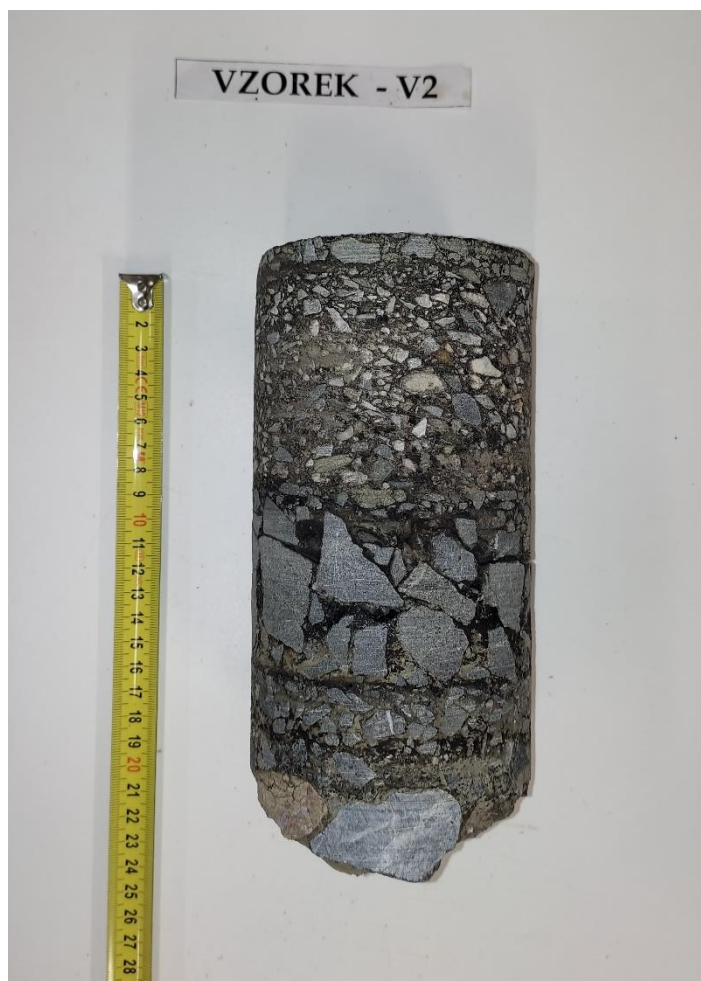
Obr. 4 - Jádru vývrtu Vzorek – V2 (laboratoř).
