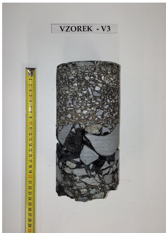
Obr. 6 - Jádru vývrtu Vzorek – V3 (laboratoř).
