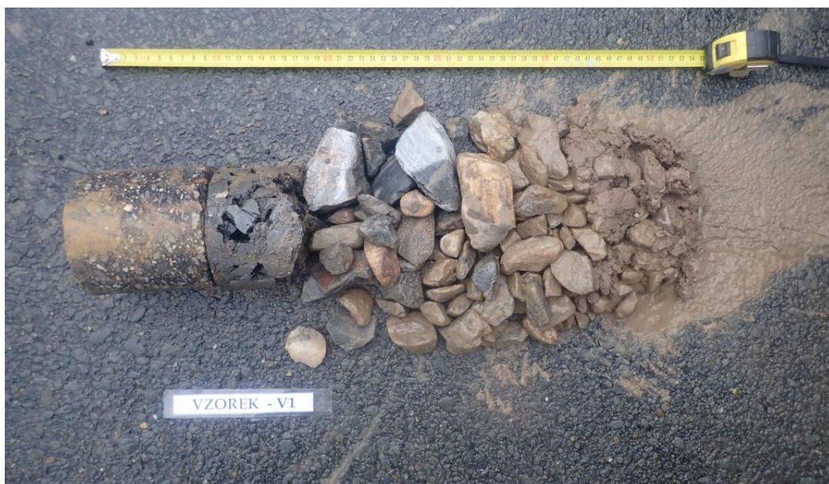
Obr. 1 - Jádro vývrtu Vzorek – V1 (in situ).
