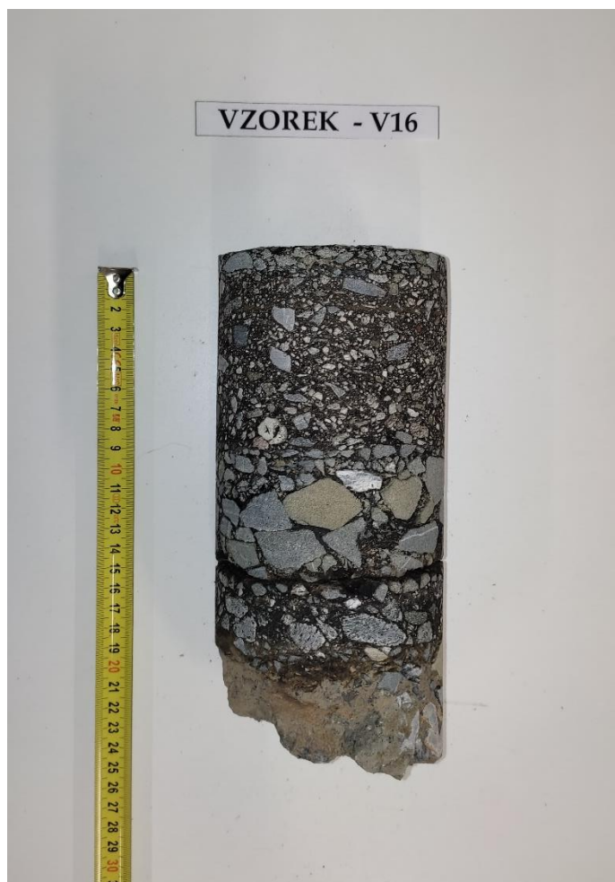
Obr. 32 - Jádru vývrtu Vzorek – V16 (laboratoř).
