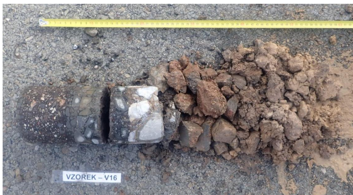
Obr. 31 - Jádro vývrtu Vzorek – V16 (in situ).
