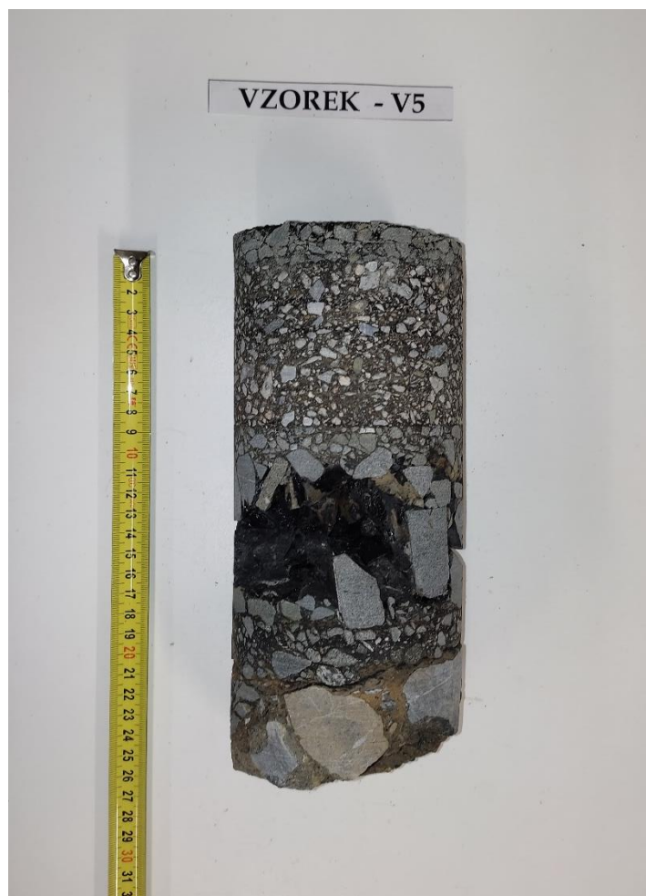
Obr. 10 - Jádru vývrtu Vzorek – V5 (laboratoř).
