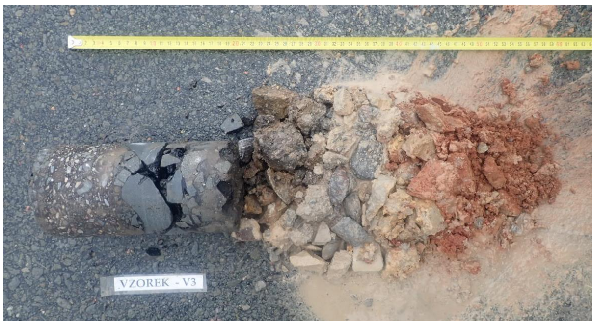
Obr. 5 - Jádro vývrtu Vzorek – V3 (in situ).
