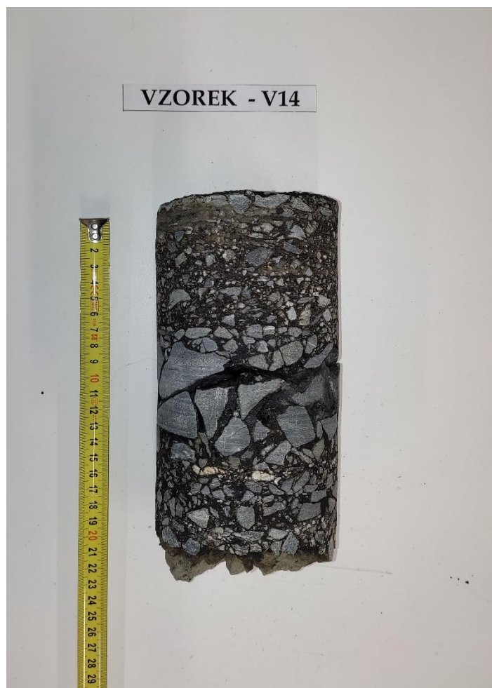
Obr. 28 - Jádru vývrtu Vzorek – V14 (laboratoř).
