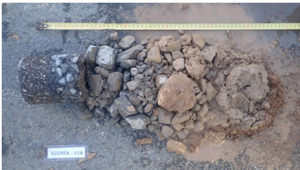
Obr. 35 - Jádru vývrtu Vzorek – V18 (in situ).
