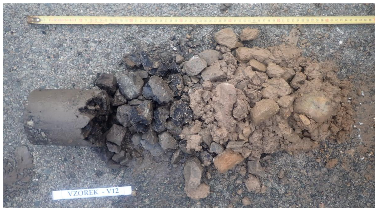
Obr. 23 - Jádro vývrtu Vzorek – V12 (in situ).
