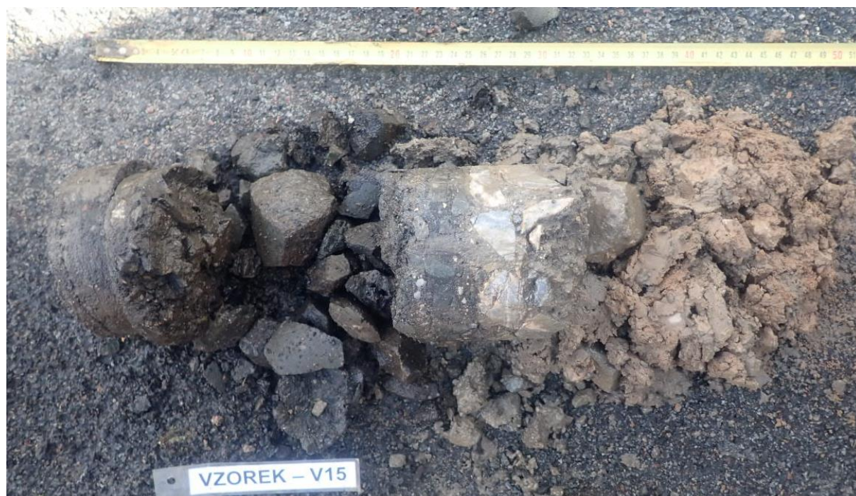
Obr. 29 - Jádro vývrtu Vzorek – V15 (in situ).
