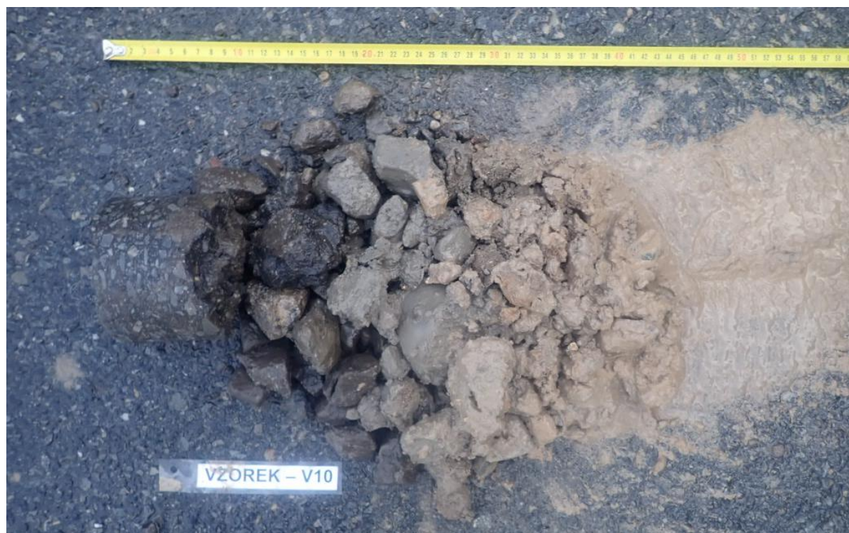
Obr. 19 - Jádro vývrtu Vzorek – V10 (in situ).
