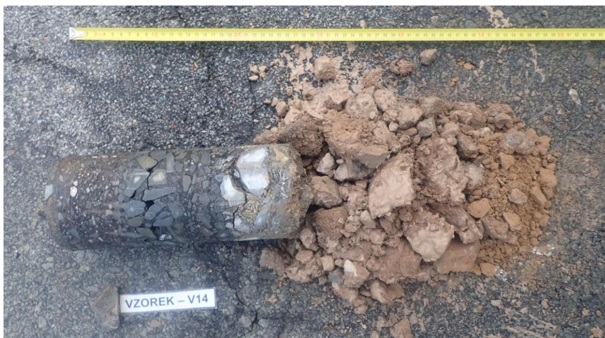
Obr. 27 - Jádru vývrtu Vzorek – V14 (in situ).
