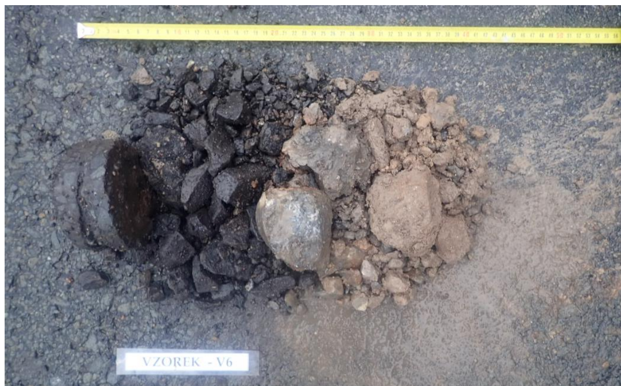
Obr. 11 - Jádro vývrtu Vzorek – V6 (in situ).
