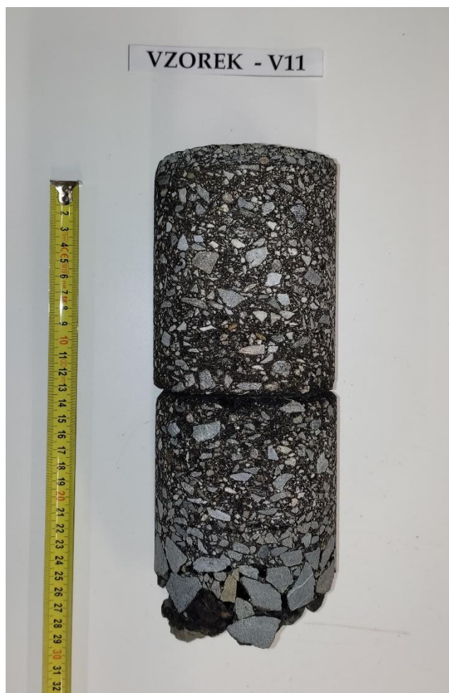
Obr. 22 - Jádru vývrtu Vzorek – V11 (laboratoř).
