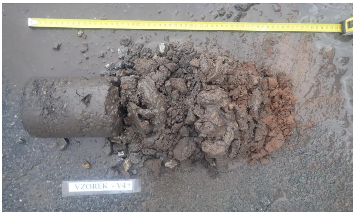
Obr. 7 - Jádru vývrtu Vzorek – V4 (in situ).
