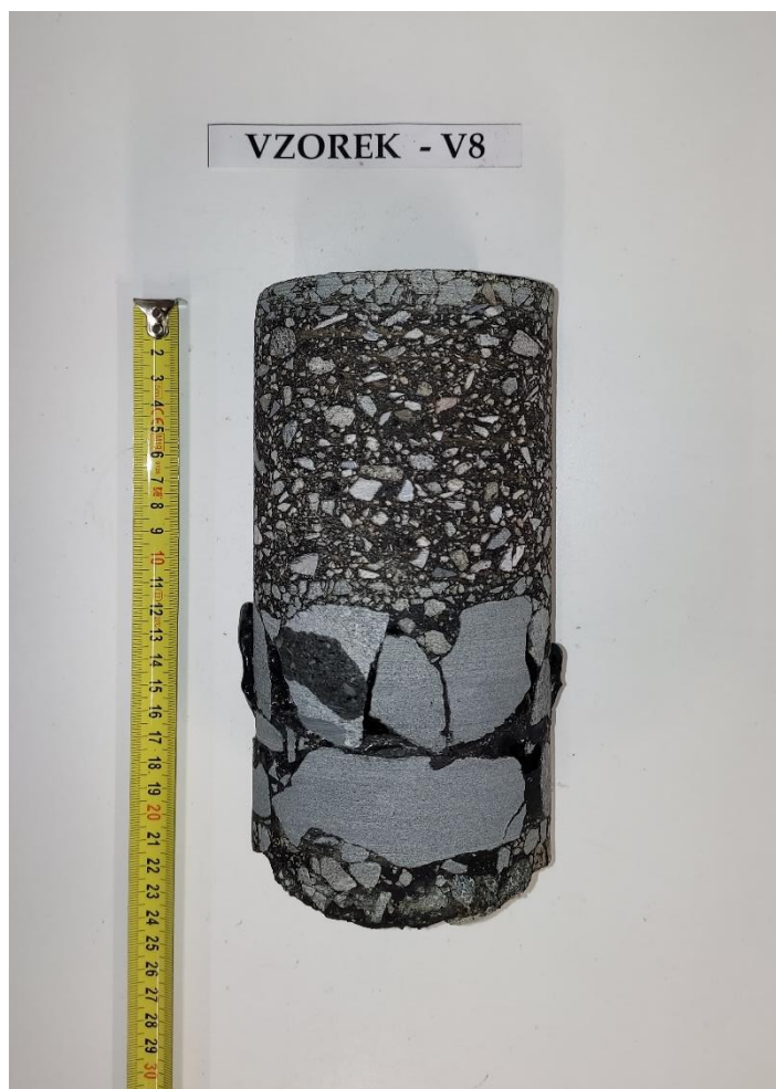
Obr. 16 - Jádru vývrtu Vzorek – V8 (laboratoř).
