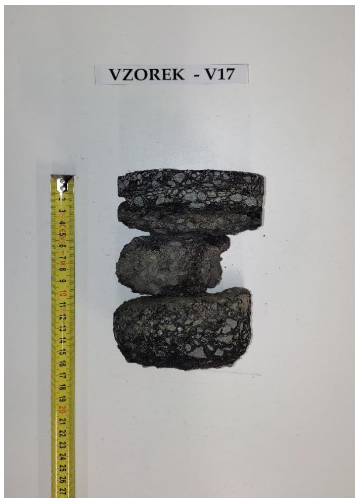
Obr. 34 - Jádru vývrtu Vzorek – V17 (laboratoř).
