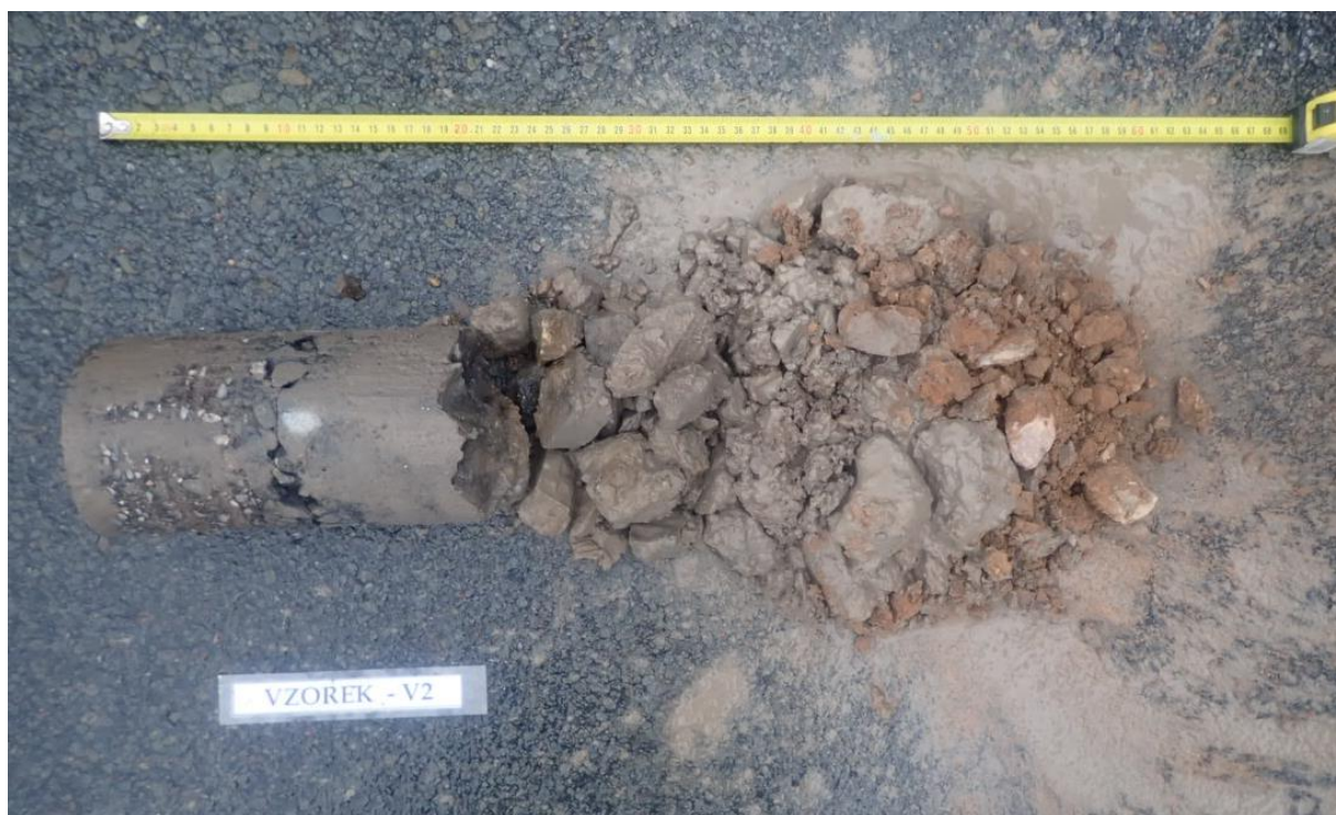
Obr. 3 - Jádro vývrtu Vzorek – V2 (in situ).
