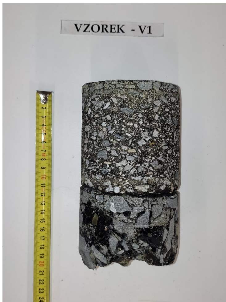
Obr. 2 - Jádru vývrtu Vzorek – V1 (laboratoř).
